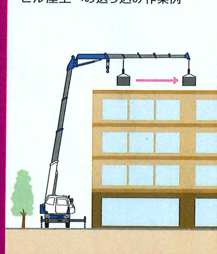
ビル屋上への送り込み作業例
